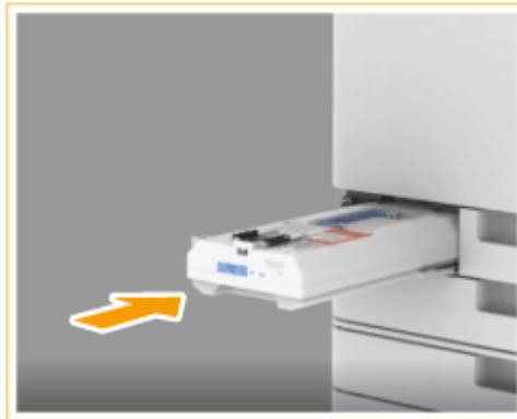
Poussez le réceptacle de toner usagé aussi loin que possible. Si le réceptacle de toner usagé n'est pas installé correctement, le dispositif de fermeture du réceptacle peut ne pas être activé lors de son retrait, ce qui peut provoquer la dispersion du toner.
